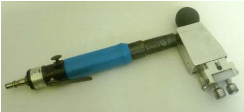
СПЕЦИНСТРУМЕНТ ДЛЯ ОБЖИМА УПЛОТНИТЕЛЯ ДВЕРЕЙ (ПНЕВМАТИЧЕСКИЙ) для Мерседеса и Рено
