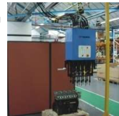
Десятишпиндельная установка ОАО «ЗМЗ» г.Заволжье
